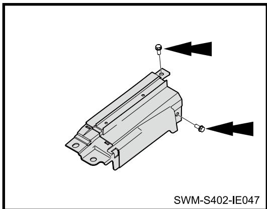
(g). 拆卸机舱左、右装饰罩固定螺栓。
