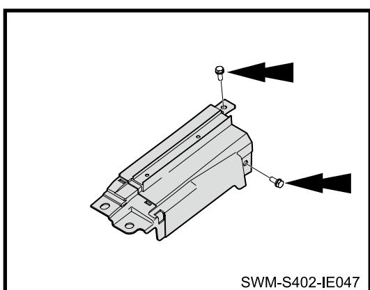
(a). 安装机舱左、右装饰罩固，并紧固固定螺栓
